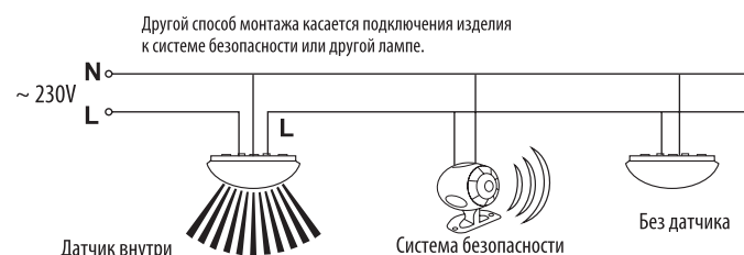
СХЕМА ЭЛЕКТРИЧЕСКИХ СОЕДИНЕНИЙ - (два способа выполнения соединений)
